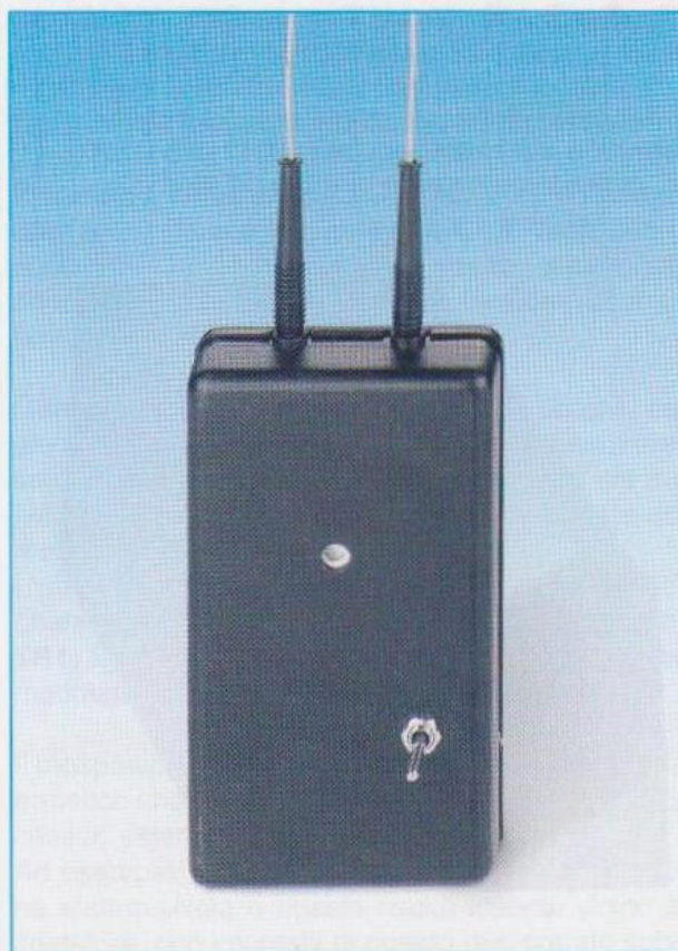
Fig.1 Schema elettrico dell'indicatore di umidità per piante. Sotto, il circuito a montaggio ultimato, racchiuso nel mobiletto plastico. Potete notare il foro per far fuoriuscire il suono della cicalina, l'interruttore e i 2 puntali della sonda.
