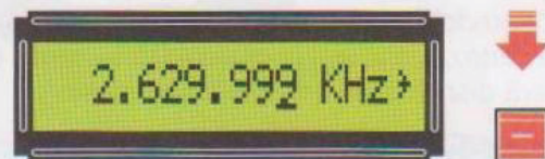
Fig.34 Se dopo avere sottolineato lo 0 a destra premete il tasto -, anziché il tasto +, otterrete una sottrazione, quindi sul display apparirà 2.629.999 KHz.
