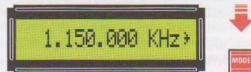
Fig.36 Per passare sulla gamma 1,15-1,4 GHz, si spegne il Generatore UHF, poi lo si riaccende tenendo premuto il pulsante Mode posto sul pannello del mobile.
