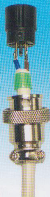
Fig.15 Chi desidera utilizzare il suo diffusore rettangolare con la Magnetoterapia di BF a 100 Gauss, deve sostituire il connettore con una presa DIN12F.
